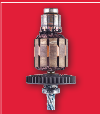
Doorgebrande motor wegens overbelasting.
