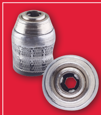
Boorhouder defect door onoordeelkundig gebruik
